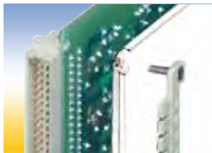
Montage der Leiterplattenabdeckung für Kodierleiste "Stufe" unter die Kodierleiste geklemmt
