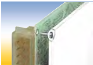
Montage der Standard-Leiterplattenabdeckung an der Steckverbinderseite
