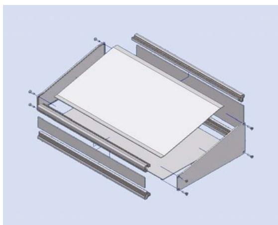
Durch Formgestaltung der Deckbleche und unterschiedliche Oberflächen lassen sich individuelle Designanforderungen realisieren.
